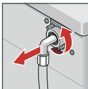
Снимите шланг со спинки прибора.
