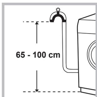
Повесьте загнутый конец сливного шланга на край раковины, ванны, или поместите в специальный вывод канализации. Шланг не должен перегибаться. Верхняя точка сливного шланга должна находиться на высоте 65-100 см от пола. Расположение сливного шланга должно обеспечивать разрыв струи при сливе (конец шланга не должен быть опущен в воду). В случае крепления на край ванной или раковины, шланг вешается с помощью направляющей (входит в
