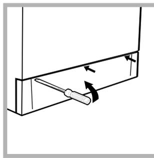
1. снимите переднюю панель стиральной машины при помощи отвертки (см. рис.);
