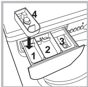
Выдвиньте распределитель и заполните его отделения моющим средством и смягчителем:
